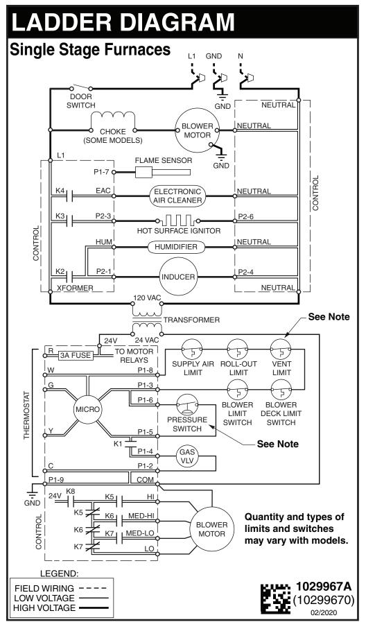
Figure 36. Nordyne/UTEC Ladder Diagram
