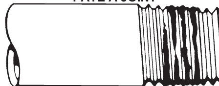
LAISSEZ 2 FILETS DÉNUDÉS Figure 5. Application de la pâte à joint
