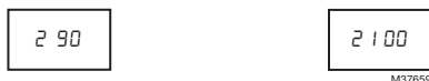
Fig. 12. Deux exemples de valeurs de l'option de configuration 2 (température de fin de cycle).
