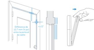
Selon la manière dont votre porte ou fenêtre est construite, vous devrez peut-être placer les capteurs à l'un des endroits indiqués ci-dessous (pourvu que les marques soient alignées et que les moitiés soient suffisamment rapprochées et se séparent lorsque la porte/fenêtre est ouverte, le capteur fonctionnera) :
