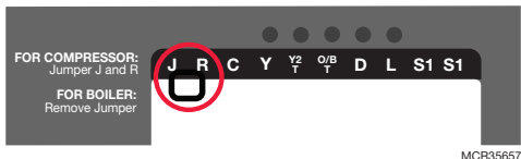
Fig. 5. Designaciones de terminales mostrando el puente entre los terminales J y R.
