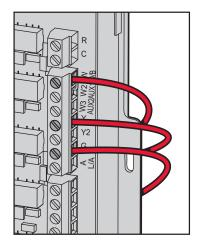
Fig. 323. Inserting wires in EIM terminal block
