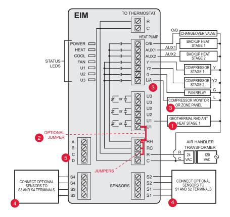
Fig. 326. EIM wiring guide - geothermal radiant heat.
